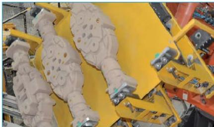
用于砂芯的夹爪安装系统/从射芯机中取出
