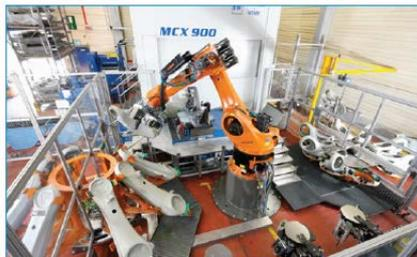
含快换装置和去毛刺主轴的夹持系统/加工中心上下料
