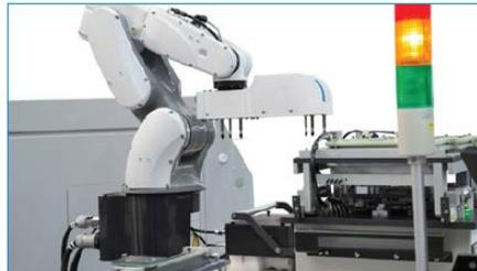
电子行业中机械手搬运印刷电路板
