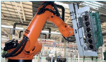
电机组机械夹爪系统 (600 kg)/装配线上下料
