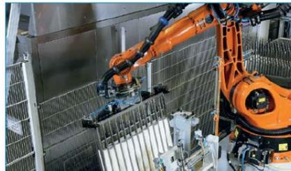
酸奶杯机械夹爪系统/从深冲机中取出，包装在硬纸板中
