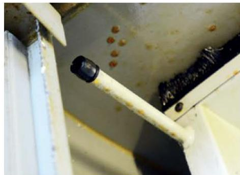
加工中心内的机门缓冲装置
